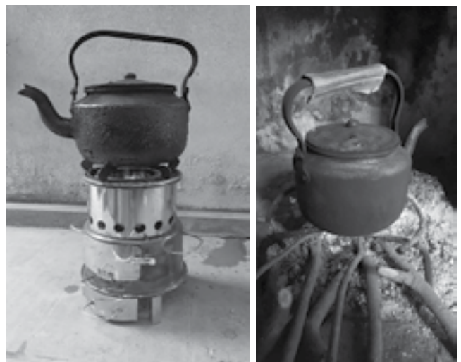
▲ Hình 2. Thử nghiệm bếp theo phương pháp đun sôi nước
